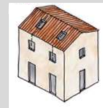
Alignement des châssis sur rythme des travées de baies des façades
